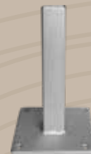
Konsolle GJ48 zum Aufdübeln, Stahl feuerverzinkt, für Alu-Pfosten, 7 x 7 cm, Maße: 16 x 16 x 60 cm
