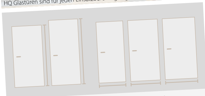
Die HQ Glastüren passen in die Zargenhöhen 198,5 und 211,0 cm und die Breiten 73,5 und 86,0 sowie 98,5 cm.
